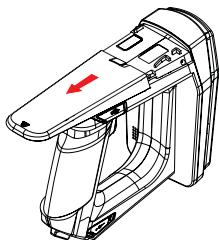
2. Schieben Sie die Abdeckung zurück und nehmen Sie vom 1800 ab. Lösen Sie die 4 Schrauben und bewahren Sie auf.
